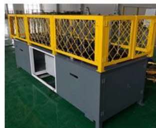
料仓系统及工件翻面定位机构 / 16工位旋转料仓(二选一)
